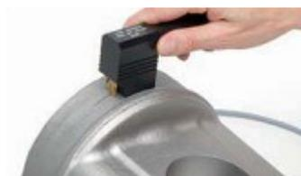
Измерение глубины наклонной трещины после определения ее угла
