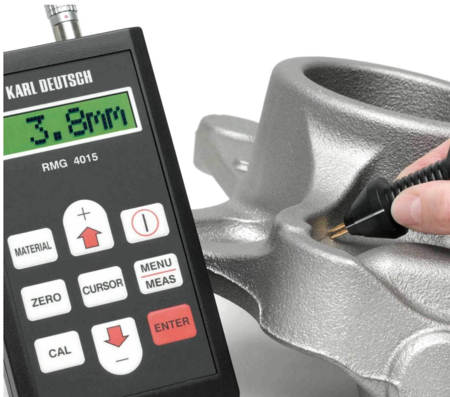
Прибор для измерения глубины трещин CDM 4015
