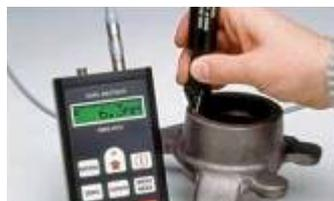
Измерение прямой трещины на малой площади
