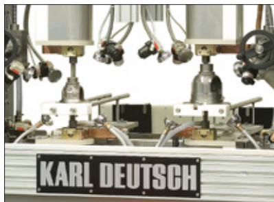
Контроль двух картеров двумя вертикальными намагничивающими станциями
