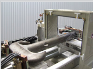
Установка с передвижной катушкой и тремя контактами для контроля больших гаков
