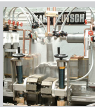
Слева: Контроль грузового поворотного цапфа ; справа: детальный вид, 4 контакта
