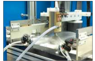
Контактное намагничивание и полив
