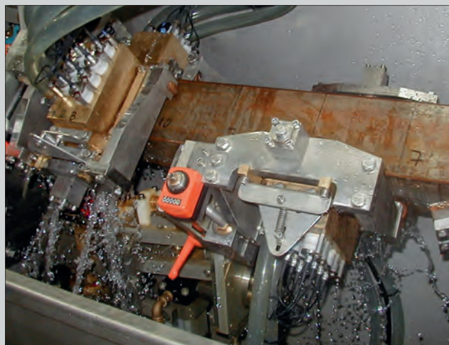
4 акустических блока для заготовок квадратного сечения, каждый имеет 7 преобразователей и расположен на каждой из четырех сторон. Перемещение осуществляется по направляющим роликам и рельсам из твёрдого металла.
