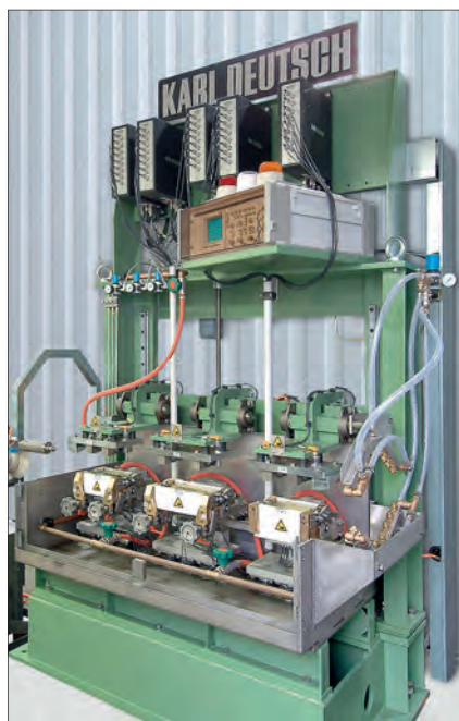
Система контроля с тремя локальными ваннами (обнаружение продольных и поперечных дефектов, измерение толщины стенки)
