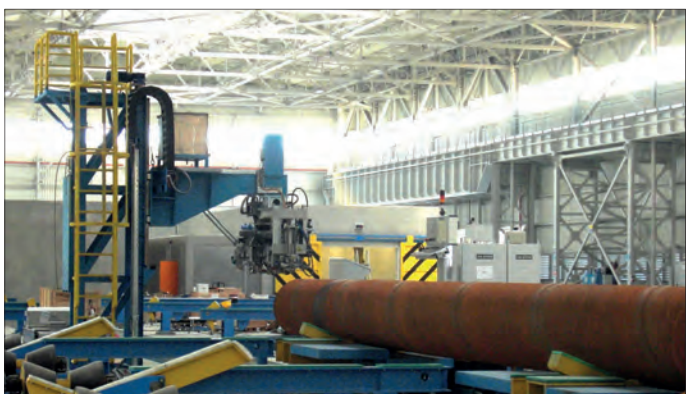
Управлять трубой можно при помощи каретки. Подача в продольном направлении и вращение должны быть идеально синхронизированы (см. изображение Borusan Mannesmann, Турция).
