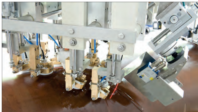
Контроль верхушки сварного шва при помощи лазерной системы оптического слежения (изображение крупным планом)
