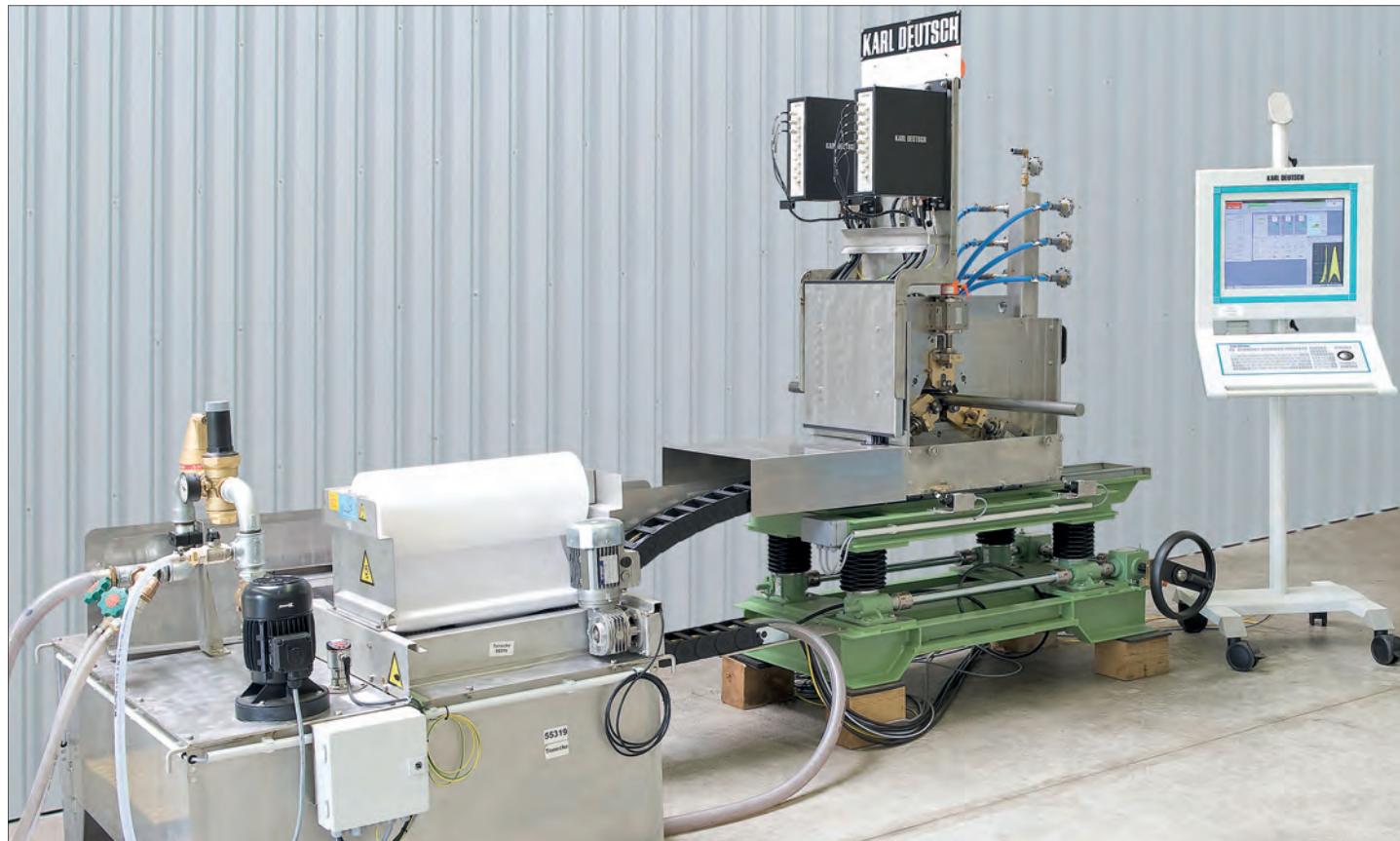
Система контроля прутков с водяным фильтром, столом для контроля и панелью оператора
