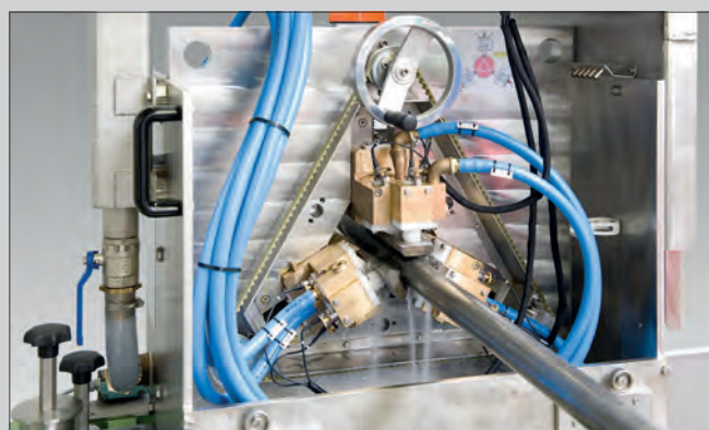
Система STP имеет 3 акустических блока. Каждый акустический блок содержит 1 преобразователь для ввода ультразвука по нормали. Два наклонных преобразователя также можно интегрировать в любой из акустических блоков для обнаружения подповерхностных дефектов.
