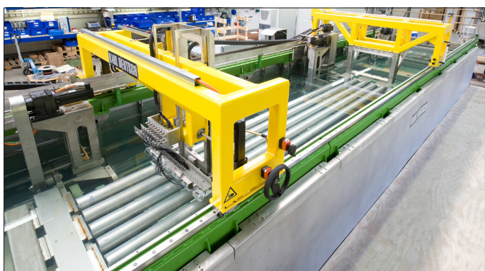
Большая иммерсионная ванна для контроля прутков, профилей и труб. До 6 образцов можно контролировать одновременно.
