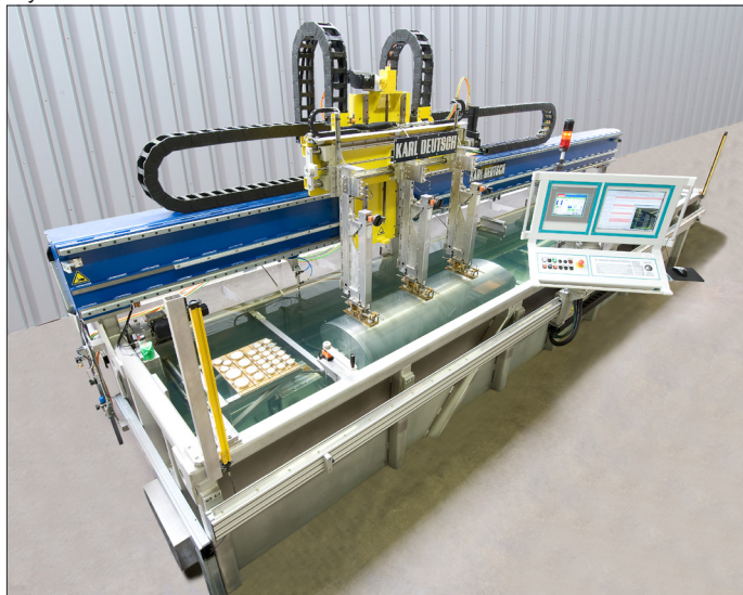
Иммерсионная ванна для контроля алюминиевой заготовки при вращении.
