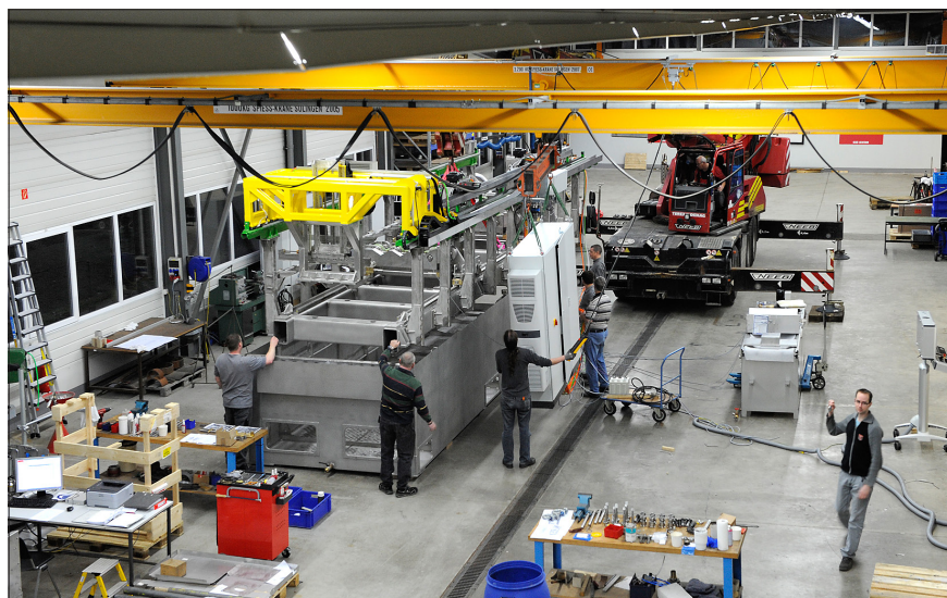
Цех в котором установлен большой иммерсионный резервуар.
