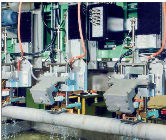
На данном изображении каждый акустический блок содержит один прямой преобразователь. Большой металлический направляющий рельс защищает преобразователь и водоструйную насадку от повреждений. Литая поверхность данной алюминиевой заготовки имеет шероховатости.
